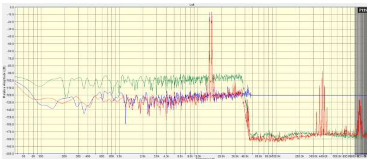
Рисунок 6. Спектр выходного сигнала при подаче на вход двух тонов с частотами 14 и 15 кГц с равными амплитудами (синий – исходный сигнал, красный – с SDM, зеленый – без SDM)
