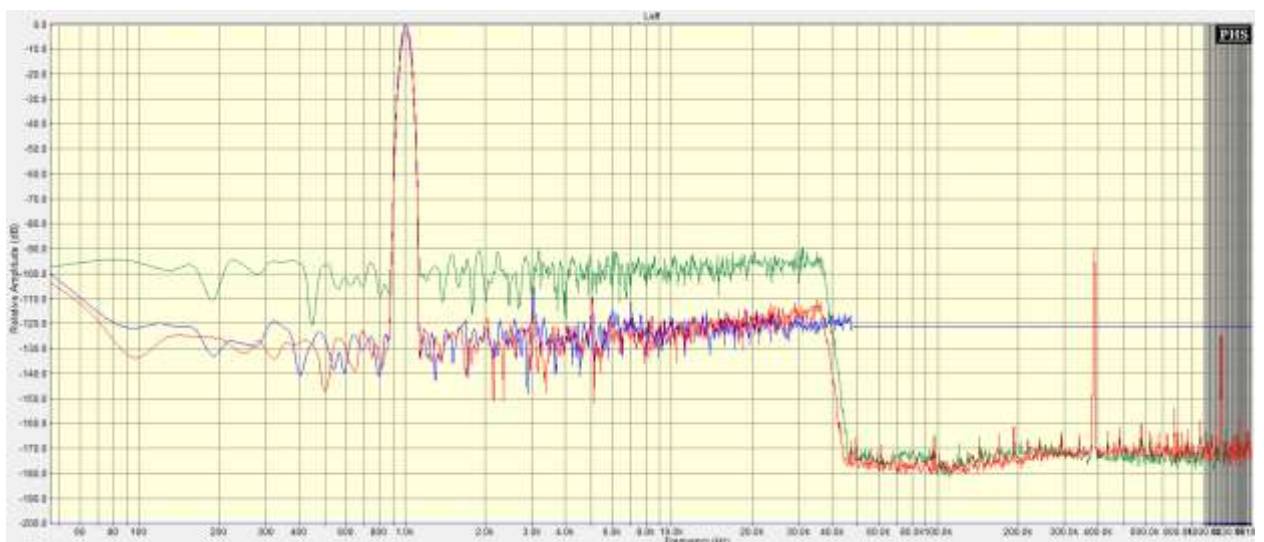
Рисунок 4. Спектр выходного сигнала на частоте 1 кГц (синий – исходный сигнал, красный – с SDM, зеленый – без SDM)
